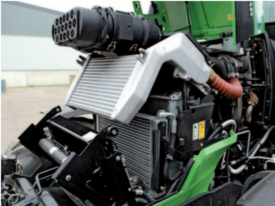
▲ Het dagelijkse en periodieke onderhoud aan de viercilinder krachtbron is onder meer dankzij het uitklapbare pakket aan koelers plezierig uitvoerbaar. De Deutz is rond z’n maximumvermogen zuinig, daarboven en daaronder iets minder. De benuttingsgraad van de motor is hoog: hij haalt 1 kW uit slechts 45 cm 3 .
