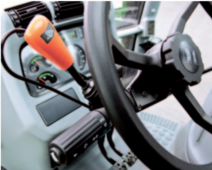
Wisselen tussen voor- en achteruit kan met deze vertrouwde hendel links onder het stuur, maar ook met de bedieningspook van de traploze transmissie rechts op de armleuning. Het geluid van de richtingaanwijzer is zwak.
