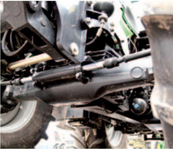
Voorasvering is standaard op de 50 km/h versie.
