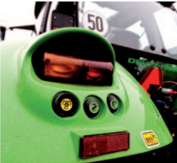
Buitenbediening voor hefinrichting en aftakas.
