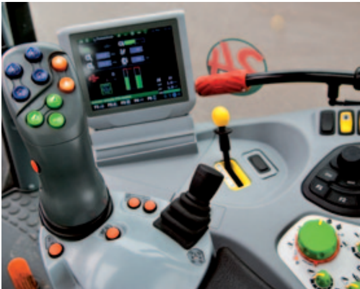
Het is even wennen aan de multifunctionele hendel (links) voor onder meer cvt, hef en hydrauliek, omdat hij in eerste instantie niet bijzonder fijngevoelig aanvoelt. Geheel rechts in het zwart de bediening van de monitor.
