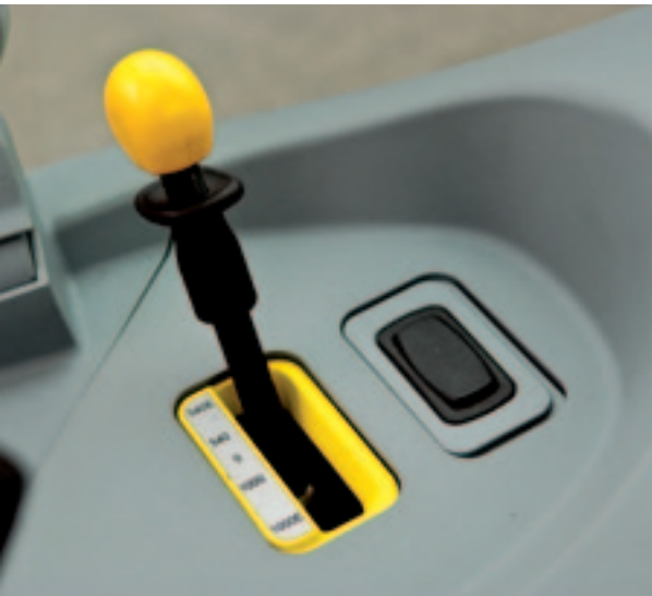
▲ Vier toeren op de aftakas zijn standaard.
