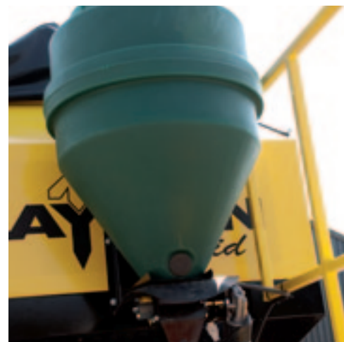
▲ Sinds kort levert Claydon de optionele micro-fertilizer om tegelijk met het zaaien kunstmest toe te dienen.
