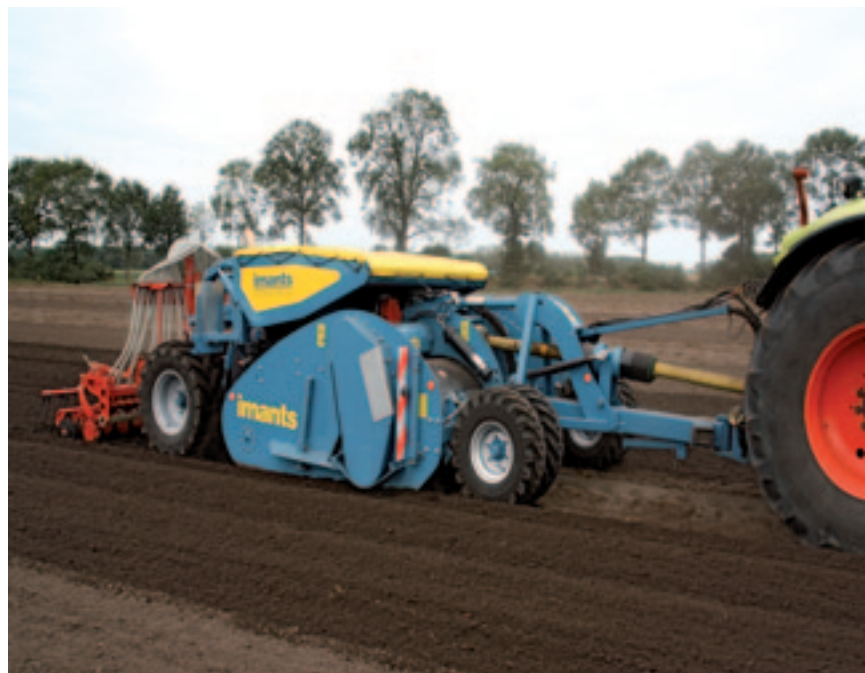
▲ De Combidrill is een getrokken spitploeg uit de 57-serie met een opbouwzaaimachine van Kverneland.
