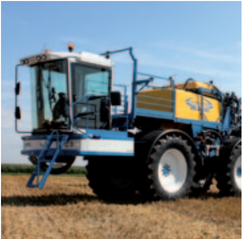
▲ Delvano heeft een nieuwe versie van de eigen cabine ontwikkeld voor op de zelfrijdende spuitmachines. Reden is dat gebruikers zeer tevreden waren over de oude Delvano-cabine. Bij de ontwikkeling heeft de spuitenfabrikant veel aandacht geschonken aan het comfort en bovendien zijn de afdichtingen sterk verbeterd. De cabine is vanaf medio 2013 leverbaar. Verder zijn de zelfrijders voortaan uitgerust met automatische vlakstelling van het voertuig voor bij gebruik van de vulpomp. Zo weet de chauffeur zeker dat de getankte hoeveelheid overeenkomt met de ingetoetste hoeveelheid.
