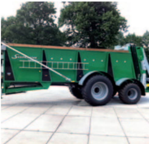
▲ Wasse laat op de beurs een nieuwe serie meststrooiers zien van Samson Agro. De meststrooiers munten volgens Wasse uit in flexibiliteit. Met één standaardframe is het mogelijk om acht verschillende modellen samen te stellen: een inhoud van 17 of 18 kuub, staande walsen of een breedstrooi-unit en een enkele as of een tandemstel. Daarbij is de kleinere bandenmaat van de achterste, meesturende wielen opvallend. Kenmerkend is verder dat de bak tussen de wielen is geplaatst. Dat biedt niet alleen de mogelijkheid om grotere wielen te monteren, het komt ook de stabiliteit ten goede.
