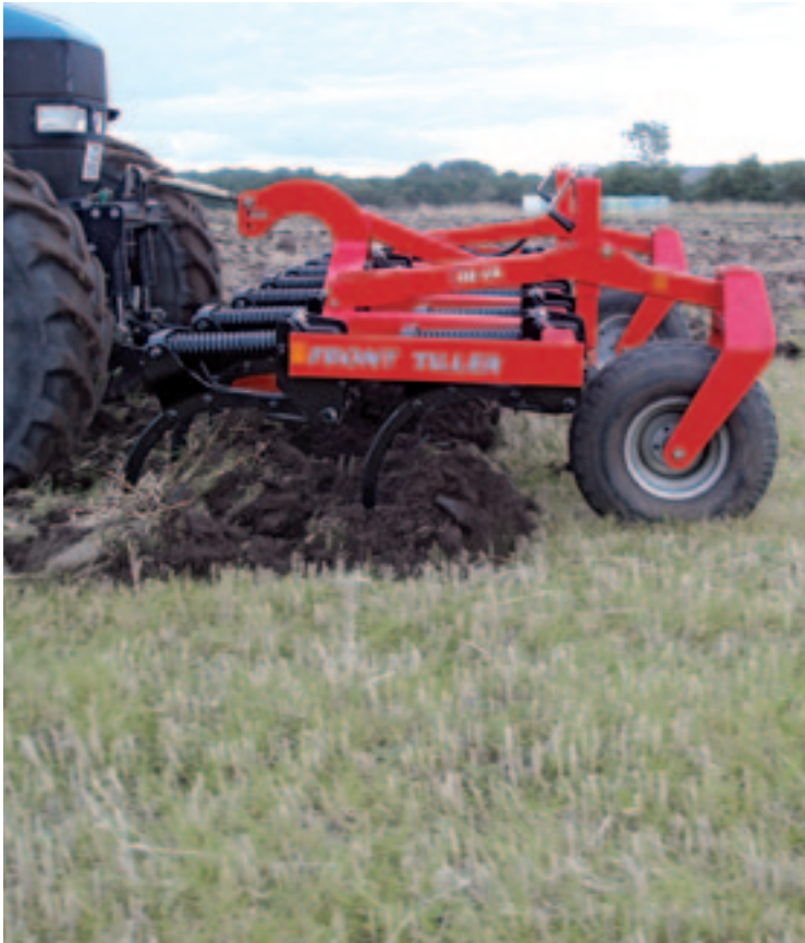
▲ Veel akkerbouwers willen werkgangen combineren. De He-Va Fronthefter komt aan die vraag tegemoet met de cultivator voor in de fronthef.
