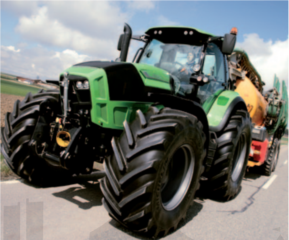
▲ Bij de stand van Deutz-Fahr is onder meer de nieuwe 6-serie te zien. De motoren van deze serie voldoen aan Stage 3b-emissie-eisen. Verder heeft de serie, die de M-serie vervangt, een nieuwe look en een vernieuwde cabine. Daarnaast toont Deutz de uitbreiding van de 7-serie met de 7230 en 7250 (foto). Deze zijn uitgerust met een traploze transmissie.
