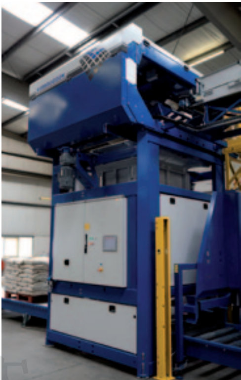
▲ Constructeurs van Verbruggen hebben de palletisermachines een facelift gegeven. Veel onderdelen zijn voortaan verwerkt in het frame en afgedekt met plaatwerk. De machines zien er niet alleen netter uit, ze zijn ook minder gevoelig voor beschadigingen.
