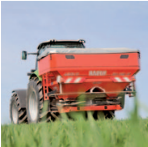
▲ Bezoekers van de Reesink-stand kunnen de Rauch-kunstmeststrooier bekijken die is uitgerust met het VariSpread-programma. Op basis van gps-plaatsbepaling kan VariSpread de strooibreedte ook op gerende percelen zo aanpassen dat er een minimale overlap ontstaat: de werkbreedte wordt in vier stappen gewijzigd. Hierbij wordt het schijventoerental en de grootte en plaats van de uitstroombopening aangepast. Nieuw van Rauch is ook het Opti-Point-programma. Op basis van gps zorgt dit ervoor dat de strooier op de kopakker op het juiste moment wordt open- en dichtgezet.
