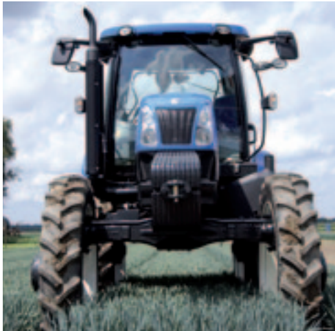
▲ Intrac in Weert toont op de ATH-beurs een New Holland-trekker uit de T6-serie met een vrije ruimte van 95 cm. Die grote ruimte onder de wielen is gecreëerd door zowel de voor- als achteras te voorzien van een set speciale tandwielen voor de portaalassen. Achterop zijn 54 inch banden gemonteerd. De hoge constructie beperkt de wendbaarheid van de trekker nauwelijks en de spoorbreedte van de trekker is nog steeds verstelbaar van 160 tot meer dan 200 cm. De ombouw is afkomstig van MJ Allen, ooit constructeur van de legendarische Ford County 4x4.
