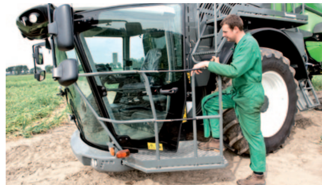
▲ De cabine van de Laser FC kan op en neer bewegen. Een verademing bij het in- en uitstappen. Het platform beweegt naar binnen als de cabine stijgt. Detail: in de 'bumper' is ledverlichting geïntegreerd.
