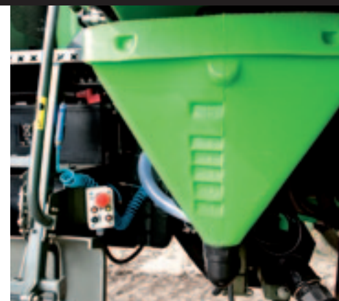
▲ De vulbak kun je hydraulisch laten zakken met het bedieningskastje links. Daarmee is ook het toerental van de pomp in te stellen.
