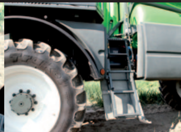
▲ Met de trap bereik je de tanks en kun je ook via een loopbrug vanuit de cabine op de grond komen.
