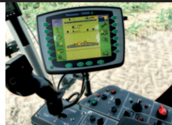
▲ De bediening van de spuit is in de rechterarmleuning ondergebracht. Spuitfuncties zijn met de joystick en de monitor te bedienen.
