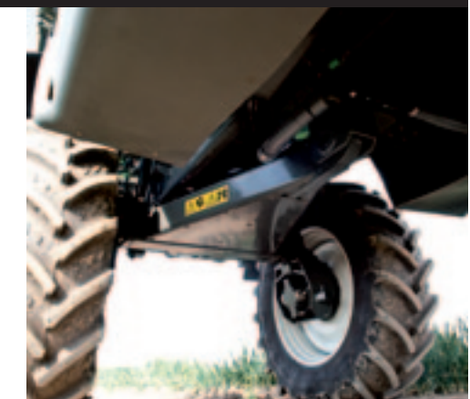
▲ Twee luchtbalgen midden voor de as zorgen voor de vering. Een kogelgewricht houdt beide wielen ook op oneffen terrein aan de grond.
