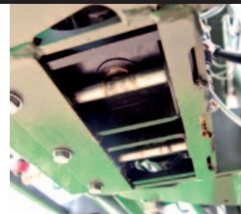
▲ Het dempingsmechanisme van de spuitboom. De linker- en rechterhelpt nemen elkaars schokken op met een rubber blok.
