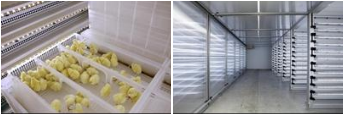
Figuur 12 Foto links: Bak met Hatchbrood kuikens. Kuikens hebben beschikking of voer en water. Foto rechts: Hatchbrood machine (Foto's: HatchTech Incubation Technology).
