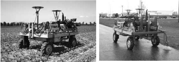
Figuur 8. Autonoom rijdend platform voor onkruid wieden in het veld (links) en autonoom borstelen van wegranden (rechts).
