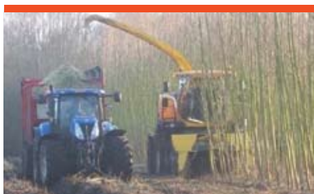
Korte omloophout wordt geoogst met een maïshakselaar.
