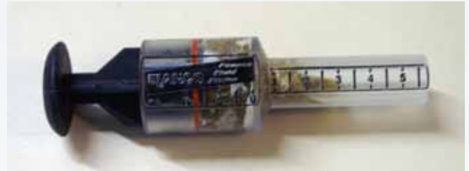
Foto 2: Met de FFF-spuit bepaal je het vochtgehalte in de mest.
