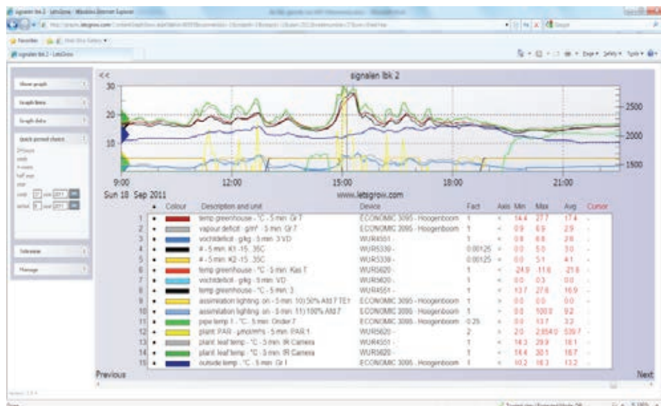
Figuur 12. Inschakelen van ventilator en buitenluchtklep en verloop van de temperatuur na gietbeurt op 18 sept.
