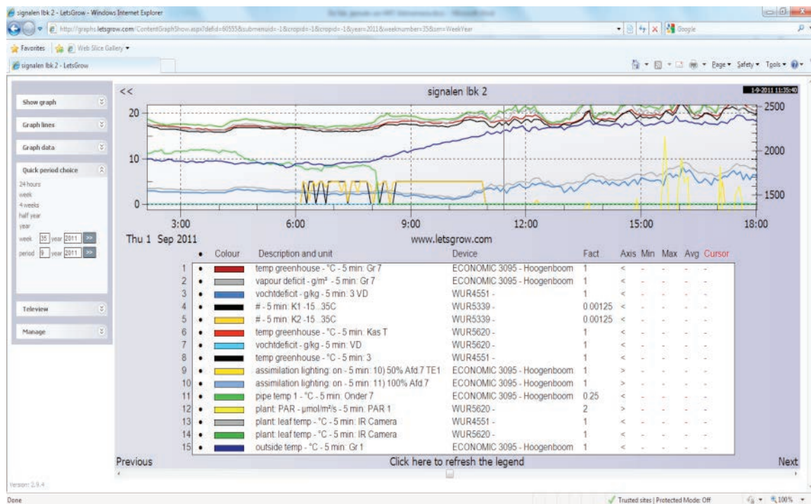
Figuur 14. Inschakelen van ventilator en buitenluchtklep en verloop van de temperatuur na gietbeurt op 1 sept.
