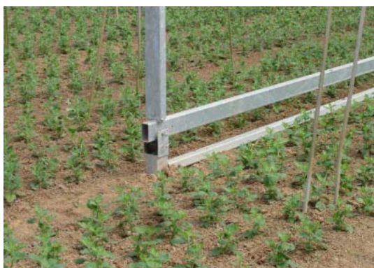
Figuur 51. Twintunnel rolkas (Amevo Techniek), kwekerij in Kerkwijk; rollen in de grond.
