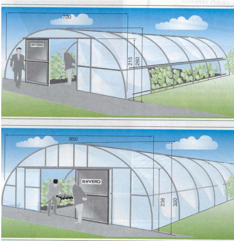
Figuur 8. Een tweetal typen folietunnels met gebogen doorsnedevorm tot op het maaiveld (Rovero).
