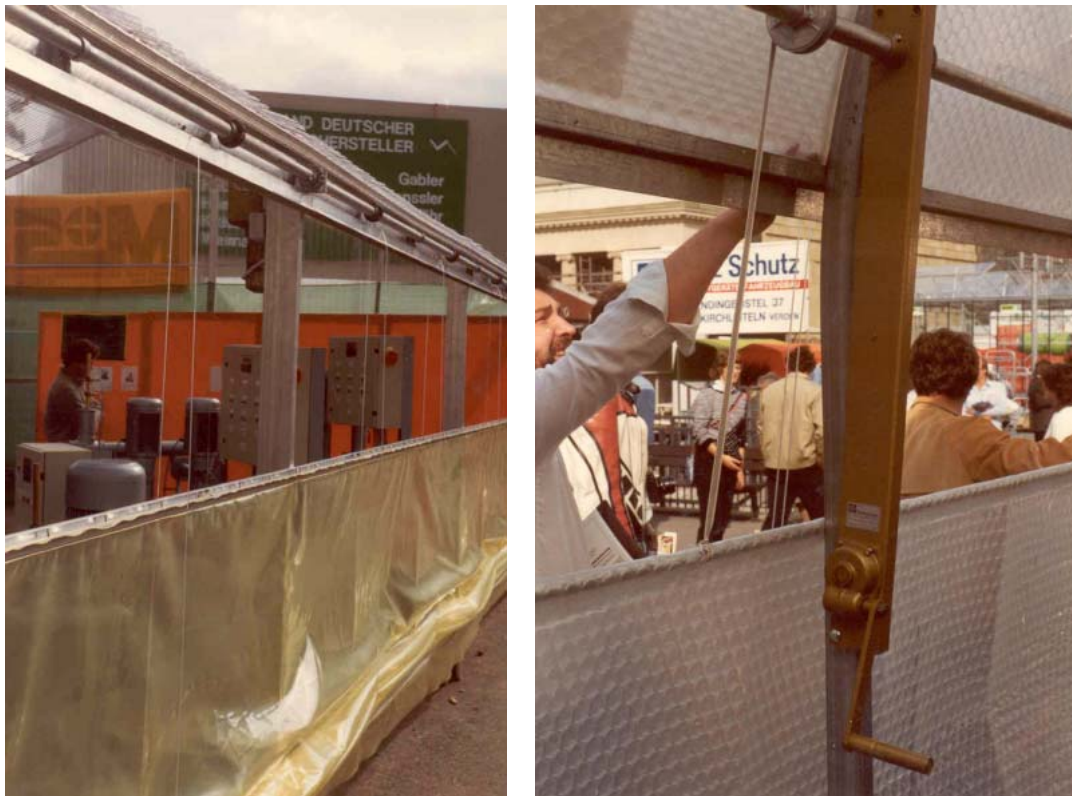
Figuur 18. Voorbeeld van een ophijsmechaniek om ventilatie via de zijgevels mogelijk te maken (Waaijenberg, 2000).
