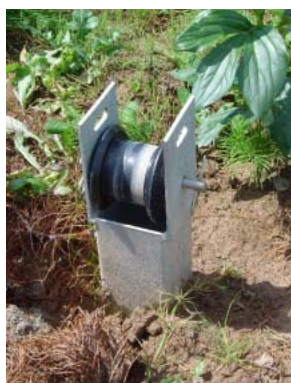
Figuur 51. Twintunnel rolkas (Amevo Techniek), kwekerij in Kerkwijk; rollen in de grond.
