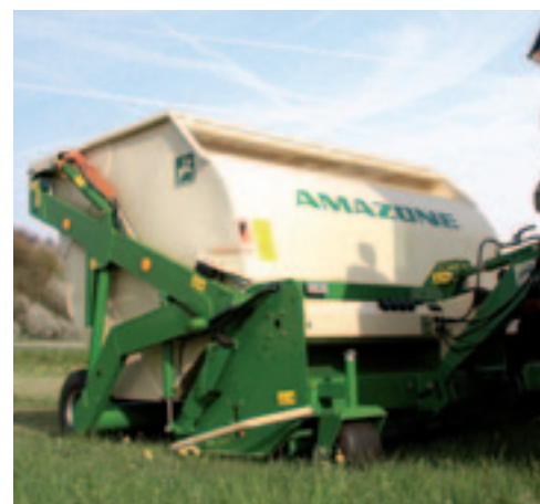
De Amazone GHS Drive kan het materiaal storten in een 2,20 meter hoge container. Op de weg kan met dit model tot 40 km/h worden gereden.
