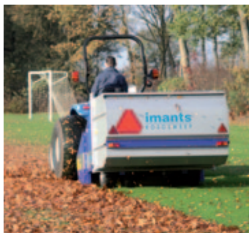
De Imants Rotosweep werkt met twee borstelrotors boven elkaar. Om het materiaal goed in de bak te werpen, draait de bovenste rotor wat sneller dan de onderste.
