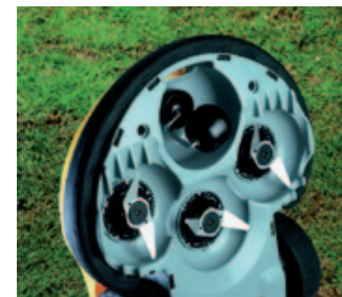
Het RL-model heeft drie kleine messen en een capaciteit tot 2000 m 2 . Bij de RM zitten zowel het neuswiel als het mes asymmetrisch.
