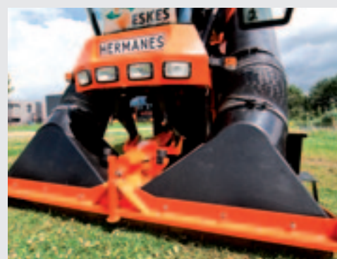
De zuigbak is 2,50 meter breed. Twee ventilatoren zuigen het vuil op en brengen het naar de 9 kuubs opvangbak.
