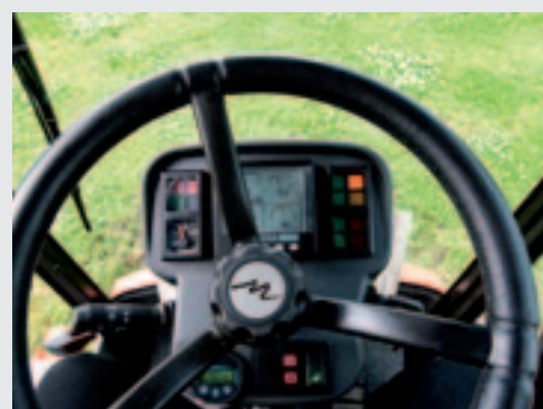
Het zicht vanuit de cabine. De zuigbak onder de cabine is net niet te zien. Het digitale dashboard toont motorinformatie.
