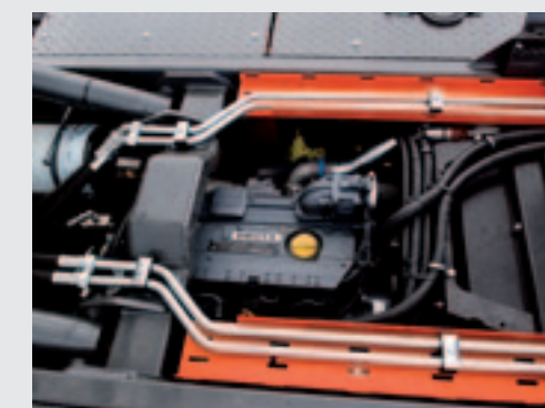
De zuigmachine wordt aangedreven door een viercilinder Deutz-motor met turbo. Deze levert 100 kW (136 pk).
