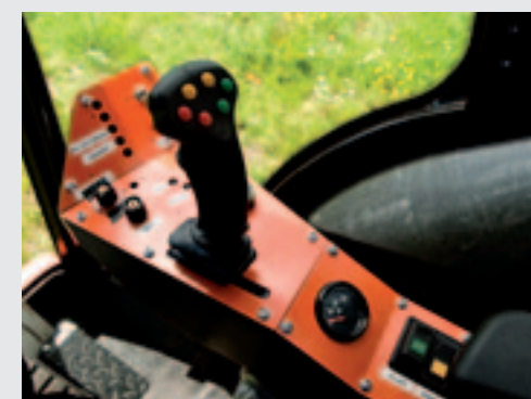
Met de joystick rechts naast de bestuurder bedien je de hydrostatische transmissie.
