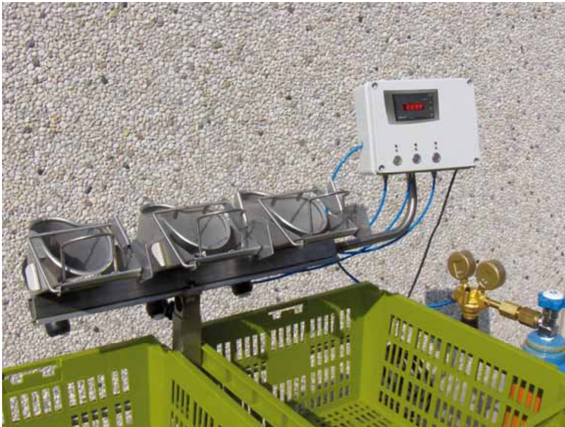
Figuur 4 Verdovingsapparaat ontwikkeld door Schippers Bladel BV
