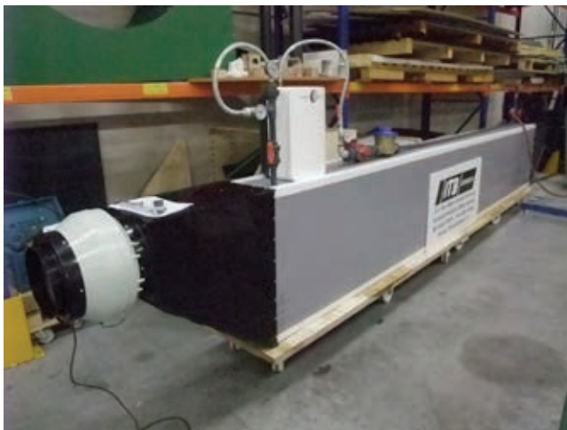
Figuur 6.1. FCA voor toepassing op een tomaten bedrijf met 100m lange slurf en plaatsing onder een teeltgoot.
