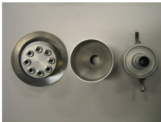
Figuur B2 Links de complete meetset met twee verschillende cyclonen (langwerpig is voor PM10) en de filterhouder en rechts de binnenkant van de luchtinlaat deze is voor beide stoffracties gelijk
