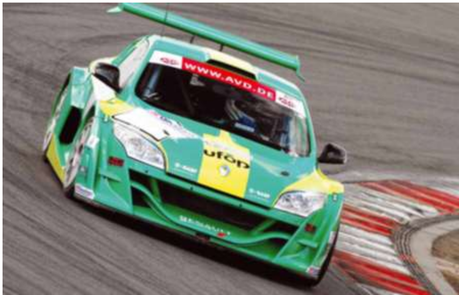
Figuur 2. Race-auto met verschillende binnen- en buitenpanelen van natuurlijke vezels en biohars, winnaar van de Composites Europe Pioneer Award 2009 (Four Motors GmbH).
