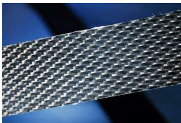
Figuur 1. Composiet met koolstofvezels (Uit proefschrift van D.P.N. Vlasveld, TU Delft, foto: DPI, Jeroen Verreijt).
