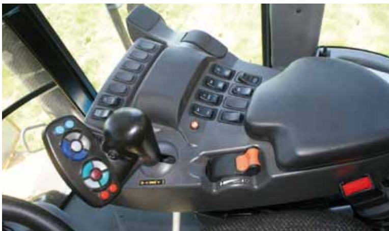
De geveerde cabine is ruim en heeft deze bekende armleningsbediening van de Amerikaanse Challenger-machines. Je kunt op de rijhendel of op het rijpedaal rijden.
