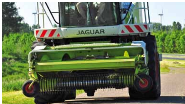
In Nederland hebben veel Duitse machines breedtemarkeringsborden, want daar is dat vanaf 2,75 meter verplicht.
