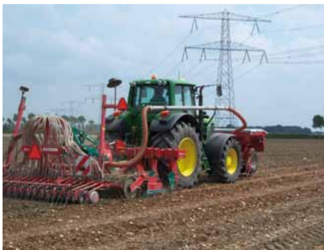
◀ Efficiëntie telt zwaar, zoals hier in één werkgang de grond met een Paraplow lostrekken, zaaiklaar maken met de zaaibedcombinatie en inzaaien van tarwe. Alle machines zijn 3,50 meter breed.
