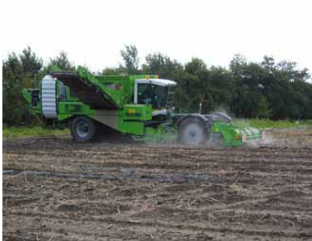
◀ Voor het aardappelrooien heeft het bedrijf twee vierrijige AVR Puma-rooiers. Echte capaciteitsmachines, die op kleine percelen worden ingezet voor het openen van het perceel.
