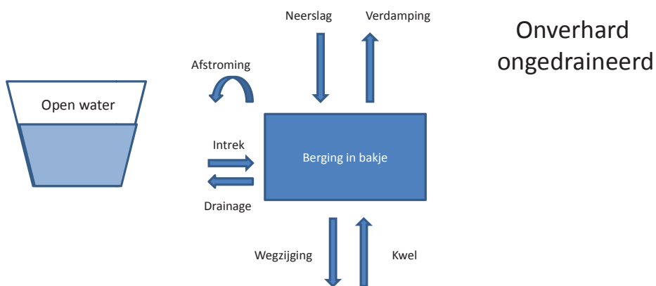
Figuur 3-7: Wisselwerking onverharde, ongedraineerde bakjes met open water
