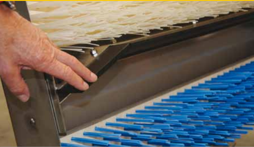
De Court-Master is met name bedoeld voor het opborstelen en verdelen van zand op roodzandtennisbanen. Een harde kunststofborstel veegt een deel van het zand uit de toplaag. De harde kunststofplaat fungeert vervolgens als het blad van een kilverbak. Ten slotte zorgt een zachtere borstel ervoor dat het zand mooi verdeeld wordt. Volgens Van Straalen werkt deze machine perfect om zand dat is weggespeeld op de baseline, egaal te verdelen over het veld.
