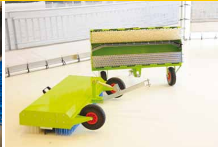
De Court-Master is met name bedoeld voor het opborstelen en verdelen van zand op roodzandtennisbanen. Een harde kunststofborstel veegt een deel van het zand uit de toplaag. De harde kunststofplaat fungeert vervolgens als het blad van een kilverbak. Ten slotte zorgt een zachtere borstel ervoor dat het zand mooi verdeeld wordt. Volgens Van Straalen werkt deze machine perfect om zand dat is weggespeeld op de baseline, egaal te verdelen over het veld.
