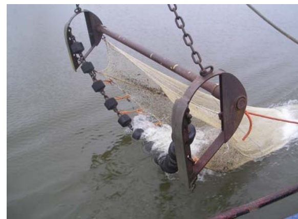
De hoofdstroom en het open water van zijwateren wordt bemonsterd met de boomkor van 3m
