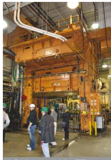
John Deere's zwaarste materiaalpers (2000 ton per cm 2 ).
