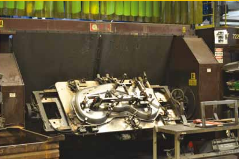
Met lasrobotten worden onderdelen aan het maaidek gesmeed.
