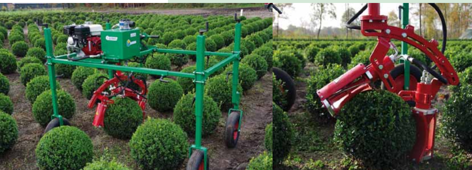
Vormsnoeimachine Globus B03 van Gebr. Ezendam uit Borne.
