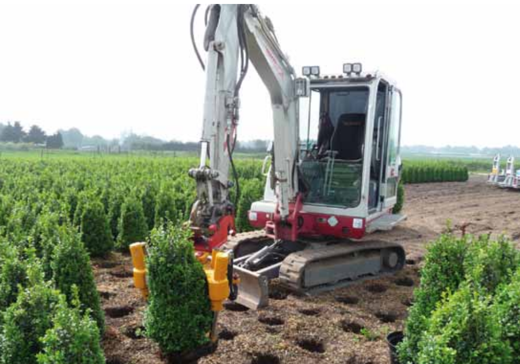
Kluitenrooimachine KLR-300 van Damcon.
