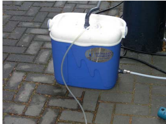
Foto 8 (links) en 9 (rechts). Uitvoering experiment met hoge doseringen ozon in aangepaste koelbox.
