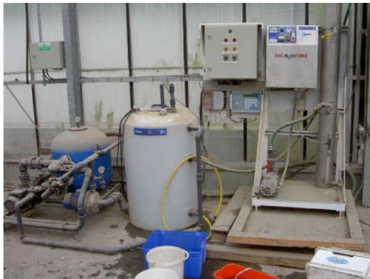
Foto 10. Installatie voor verrijken van water met O 3 Foto 11. Dompelen A+ planten in met water verrijkt O 3
