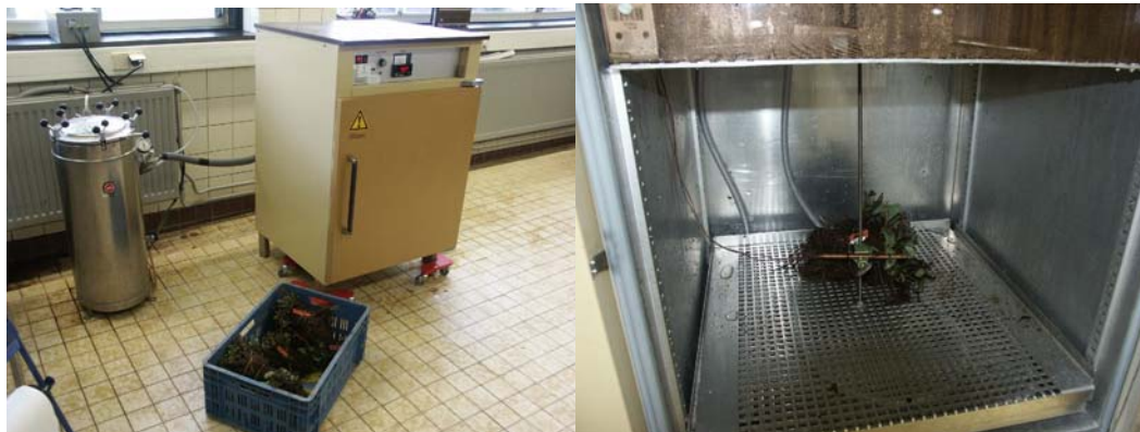
Foto 13. Klimaatkast, omgebouwd tot 'plantensauna' Foto 14. Behandeling plantmateriaal met stoom.
