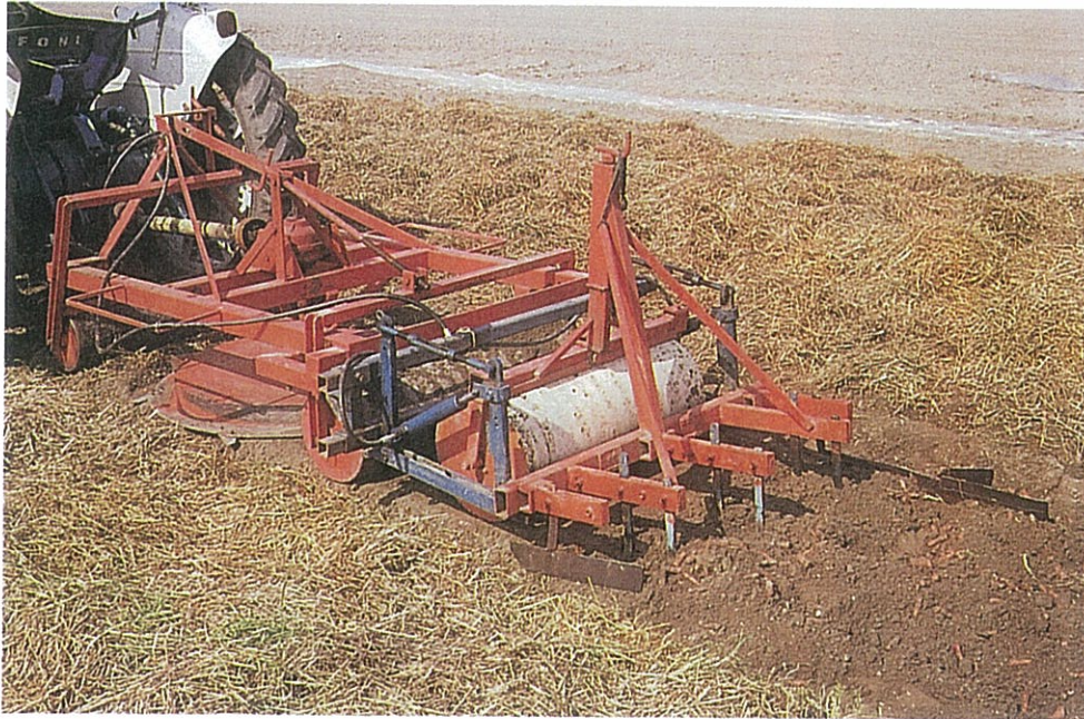
Afb. 33. Peen voor levering aan de industrie wordt op het veld gekopt en soms gesneden.
