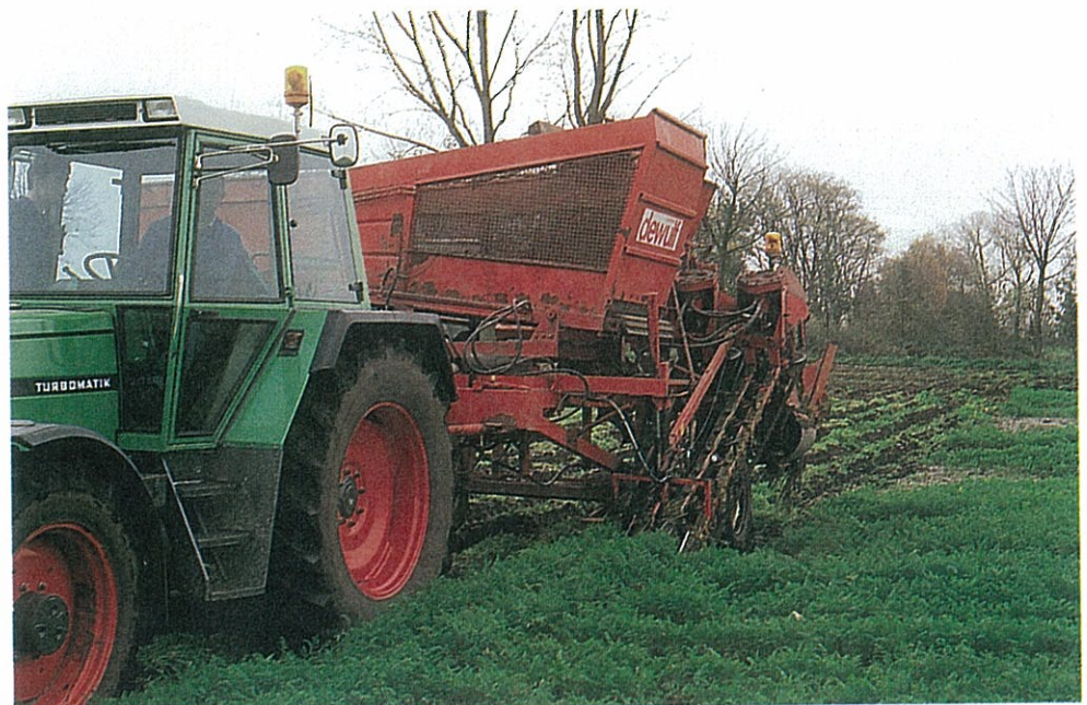
Afb. 32. Oogsten van peen aan het loof door middel van de klemband-rooier.
