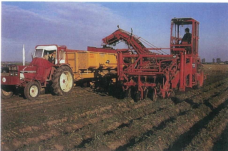
Afb. 34. Aangepaste zelfrij- dende aardappel- rooimachines worden gebruikt voor de oogst van peen, geteeld op ruggen of vlak veld.
