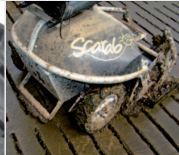
Achterop de machine zit een beugel die voorkomt dat de machine bij een drempel achteroverslaat.
