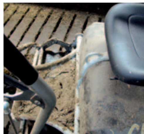
Door de machine aan deze haak op te tillen, is onderhoud eenvoudig uit te voeren.
