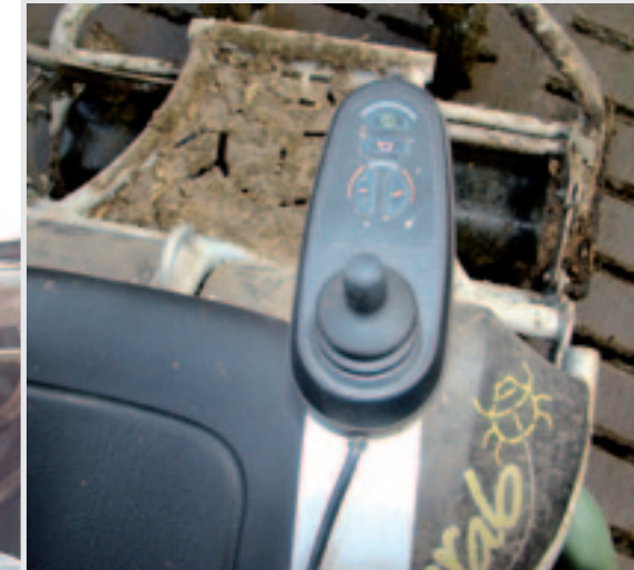
Met de joystick is de gehele roosterwals te bedienen en te besturen.
