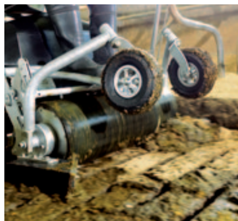
Als je scherp wilt draaien, moet je de zwenkwielen aan de grond zetten. De wals komt dan van de grond.
