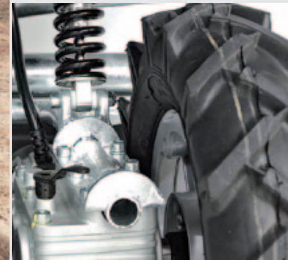
De twee achterwielen van de Scarab worden elk met een elektromotor aangedreven.
