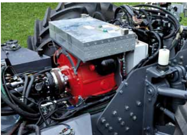
◀ Onder de cabine, op de plek van de oorspronkelijke transmissie en achterbrug, zit deze 85 kW/650-volt-generator met daarboven de Silverbox-regelunit.
