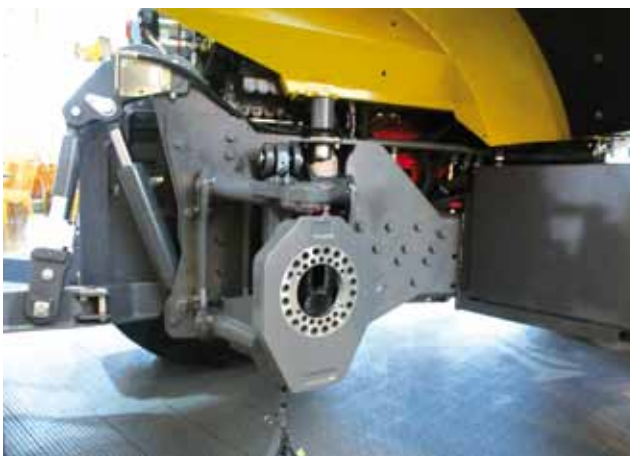
◀ De naven zijn zo geconstrueerd dat ze relatief eenvoudig aan deze plaat kunnen worden gemonteerd. De wielophanging is ook universeel te monteren.
