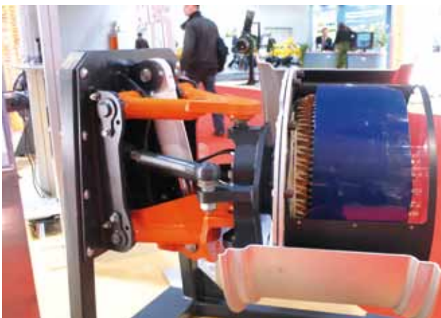
◀ De TU Dresden toonde deze doorsnede van de wielunit, met goed zichtbaar de wikkelingen in de wielnaaf, de oranje draagarmen en de witte veercilinder.
