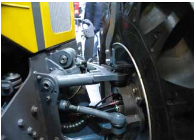
◀ Naast kabels voor de stroomvoorziening zijn de elektromotoren vloeistofgekoeld en zijn er opnemers voor de registratie van de wielsnelheid.
