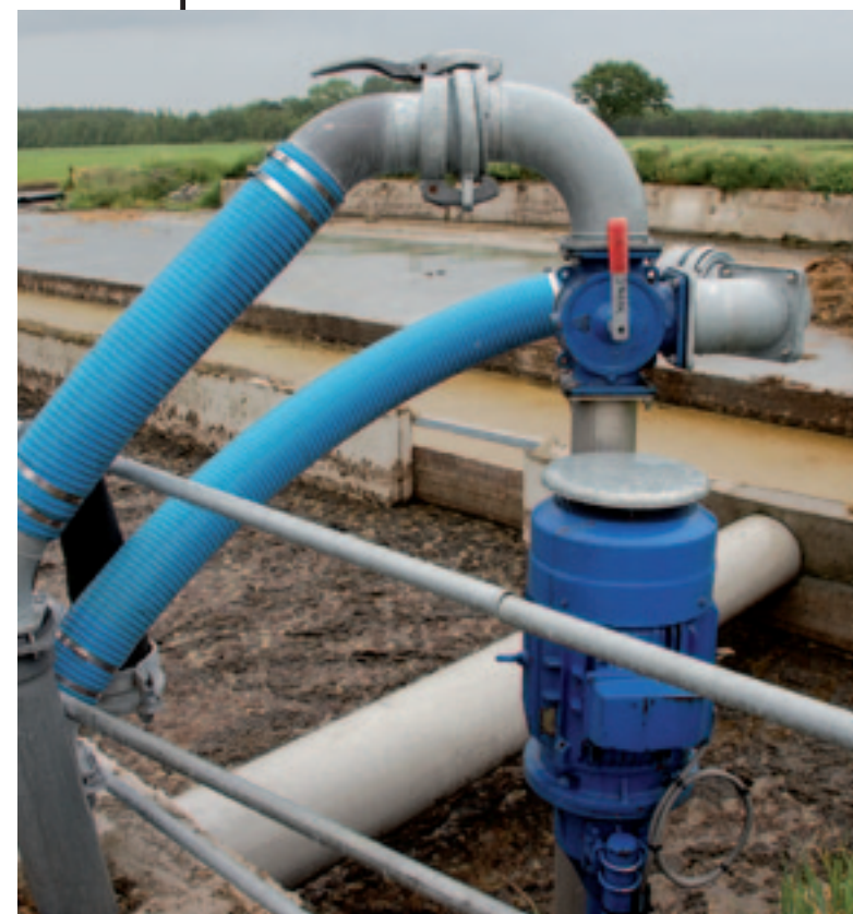
Een pompinstallatie zorgt ervoor dat de dunne mestfractie het zand uitspoelt.
