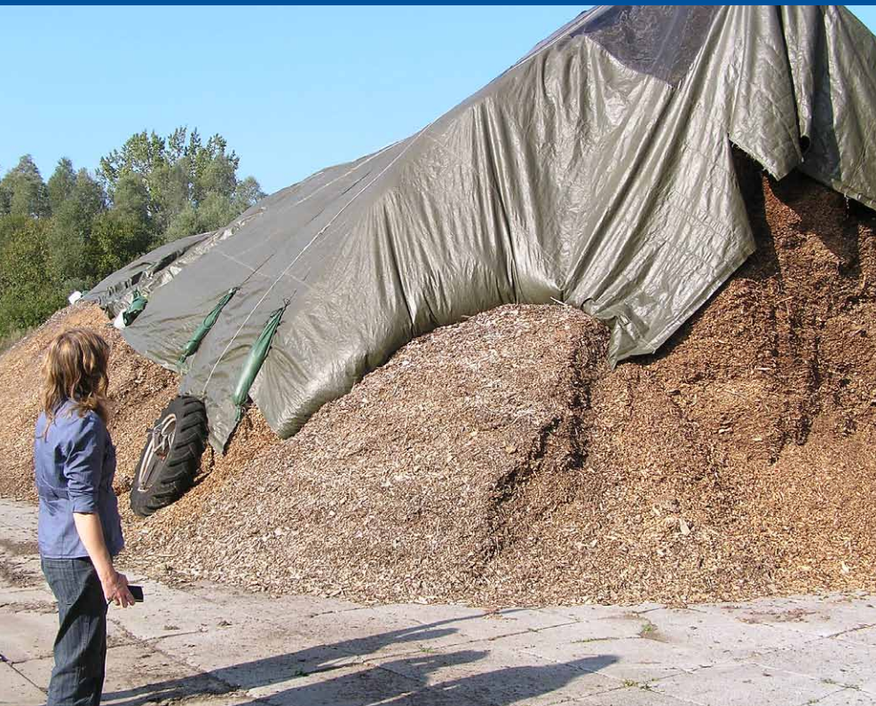
Opslag van houtsnippen onder vochtafwerend, luchtdoorlatend doek.
