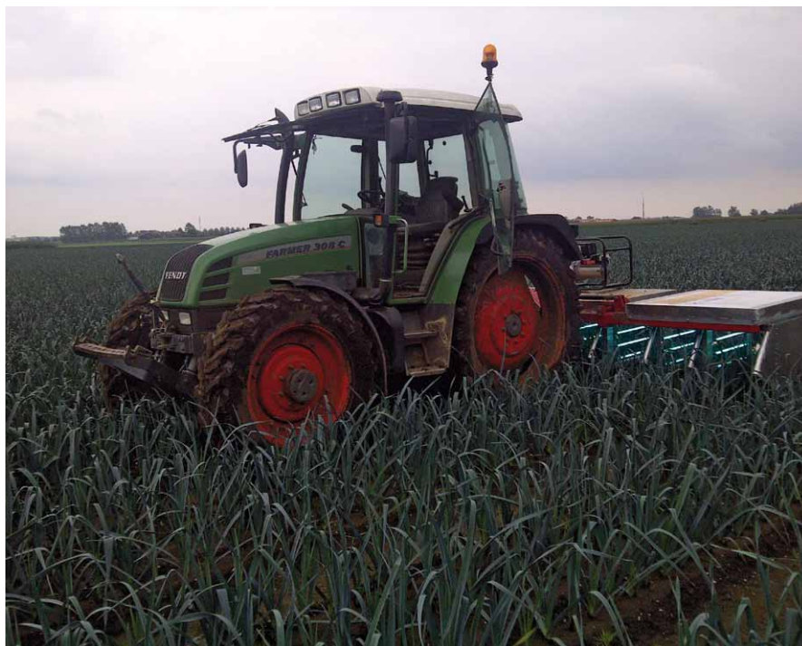
Figuur 13.2 Clean light machine in prei in actie. Bron: CLM.
