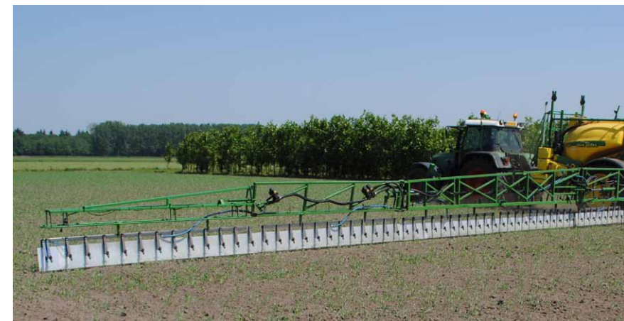
Figuur 13.1 Wingsprayer in actie. Bron: Hoeben.
