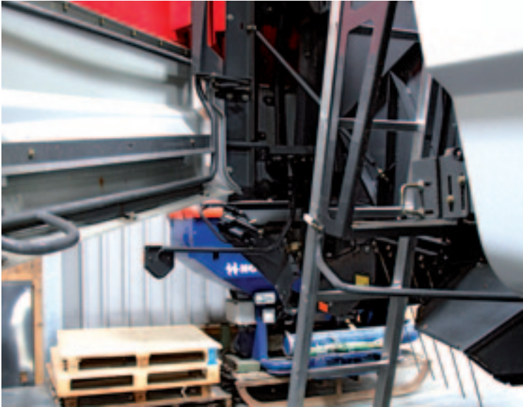
▲ Aan de buitenkant is de Centora strak afgewerkt. Achter een kunststof kap zit de ladder waarmee je het motorcompartiment kunt bereiken.
