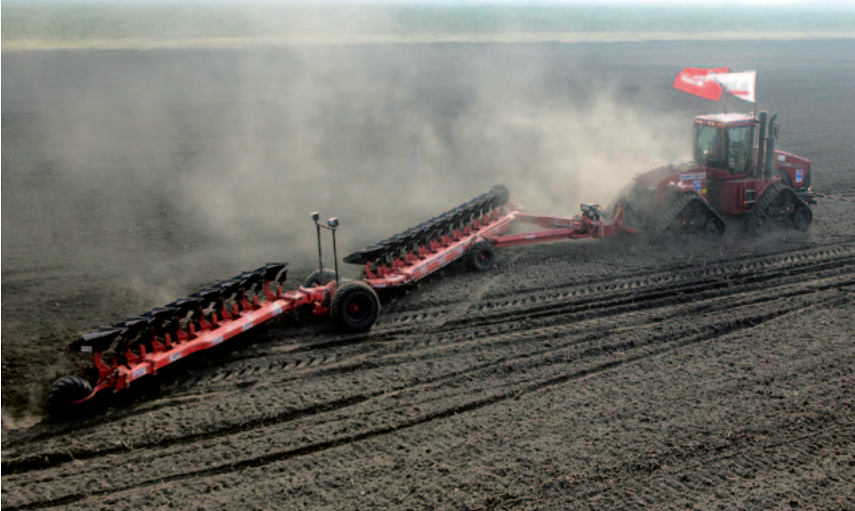
▲ Het huidige ploegrecord is in handen van Case IH en Grégoire-Besson. De ploegenbouwer maakte speciaal hiervoor een twintigscharige ploeg.
