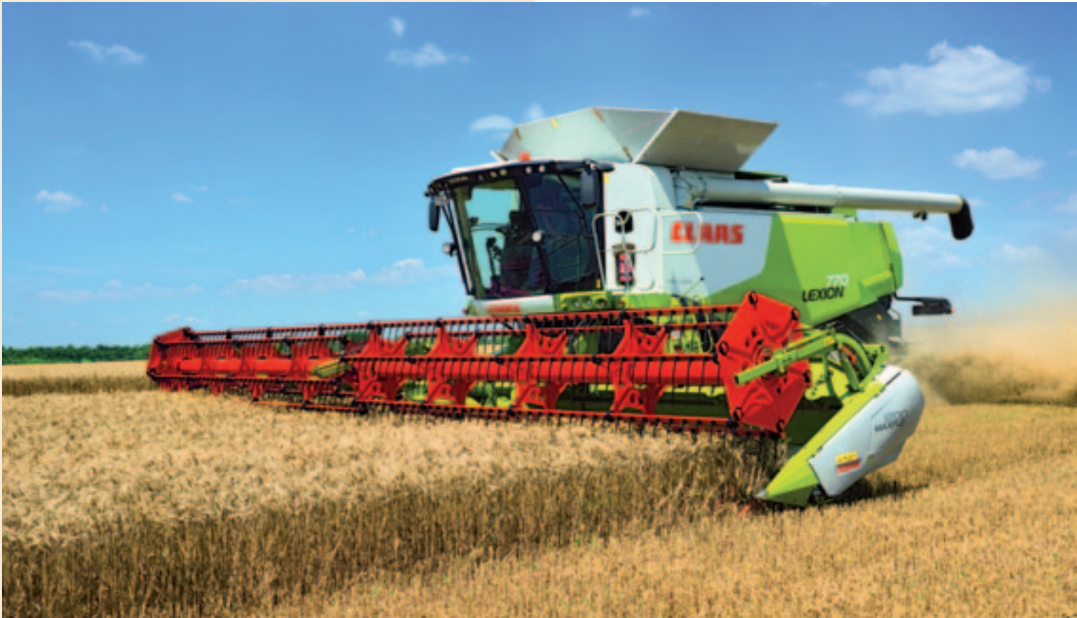
▲ Het huidige wereldrecord is in handen van Claas. Deze Lexion 770 Terra Track met een 12 meter breed maaibord dorste in 8 uur tijd 676 ton graan.
