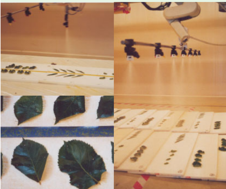
Links: Verdeling GNO met standaard spuitdop over appelblad voor bepaling van regenvastheid. Rechts: Bepaling depositiehoeveelheid en regenvastheid van combinaties van GNO-preparaten en additieven op aardappel-, lelie- en appelblad.
