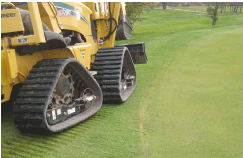
Extrem laag bodemdruk en geen risico op slippen.
