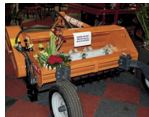
▲ Om na de winter de groei van hyacinten te bevorderen, moet het beschermende winterdek op het gewas worden verkleind. Veel telers gebruiken daarvoor de strohakselaar. Bij zo'n bewerking blijft tussen de rijen hyacinten vaak wat stro en gekiemde gerst vastzitten. Dat geeft later problemen. Van Gerven Mechanisatie uit Lisse heeft de oplossing gevonden door achter de klepelas een hydraulisch aangedreven buis met pennenkranen te monteren. Deze pennen draaien tegengesteld aan de rijrichting, precies tussen de plantrijen door, woelen het materiaal los en brengen het losse materiaal in de invloedssfeer van de klepels. Van Gerven noemt dit het Gercon pickup-systeem.
