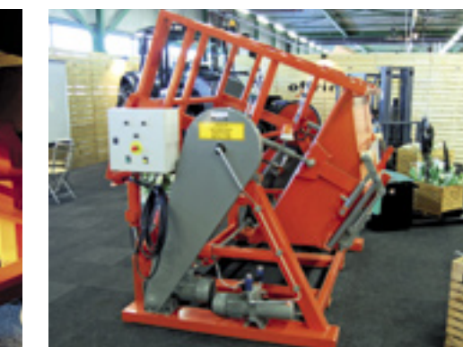
▲ In het programma van Offringa staat al jaren de Airrotator 1500/1600 kistendraaijer, te gebruiken voor het beluchten van bollen en sinds een aantal jaren voor het ontkiemen van aardappelen. In de nieuwste uitvoering is het deksel, waarmee de kisten in het roterende frame worden vastgezet, vernieuwd. Een binnenrand zorgt ervoor dat na het ronddraaien alle bollen terug in de kist komen. In de holle bodem van het deksel is een hydraulisch bediend deksel aangebracht, waardoor de inhoud op een transportband kan stromen. De machine heeft twee elektromotoren, een voor de mechanische aandrijving en een voor de hydrauliek. De Airrotator wordt aangestuurd met een opgebouwde plc.
