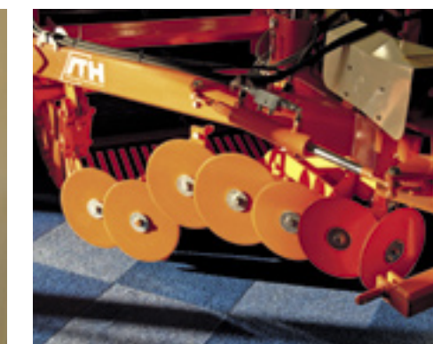
▲ De Nobels bollenrooier heeft enkele aanpassingen voor meervoudig gebruik. Naast het verzamelen rooit hij nu ook bollen op zwad. Aan de achterzijde zit dan een glijgoot. Nieuw is de mogelijkheid om de buitenste schijven van de V-vormige eenheid afzonderlijk in hoogte te kunnen verstellen. Tijdens het oprapen komen alleen die schijven in bedrijf. Zij schuiven de stroken grond met organisch materiaal naar het zwad verder naar buiten om zo met minimale beweging op de rooikettingen toch een schoon en onbeschadigd product te verzamelen. Opvallend is ook dat de trekboom van de rooier een verstekmechaniek heeft om recht voor het plantbed te komen. De zijdelingse beweging wordt ook meegenomen door de wielen.
