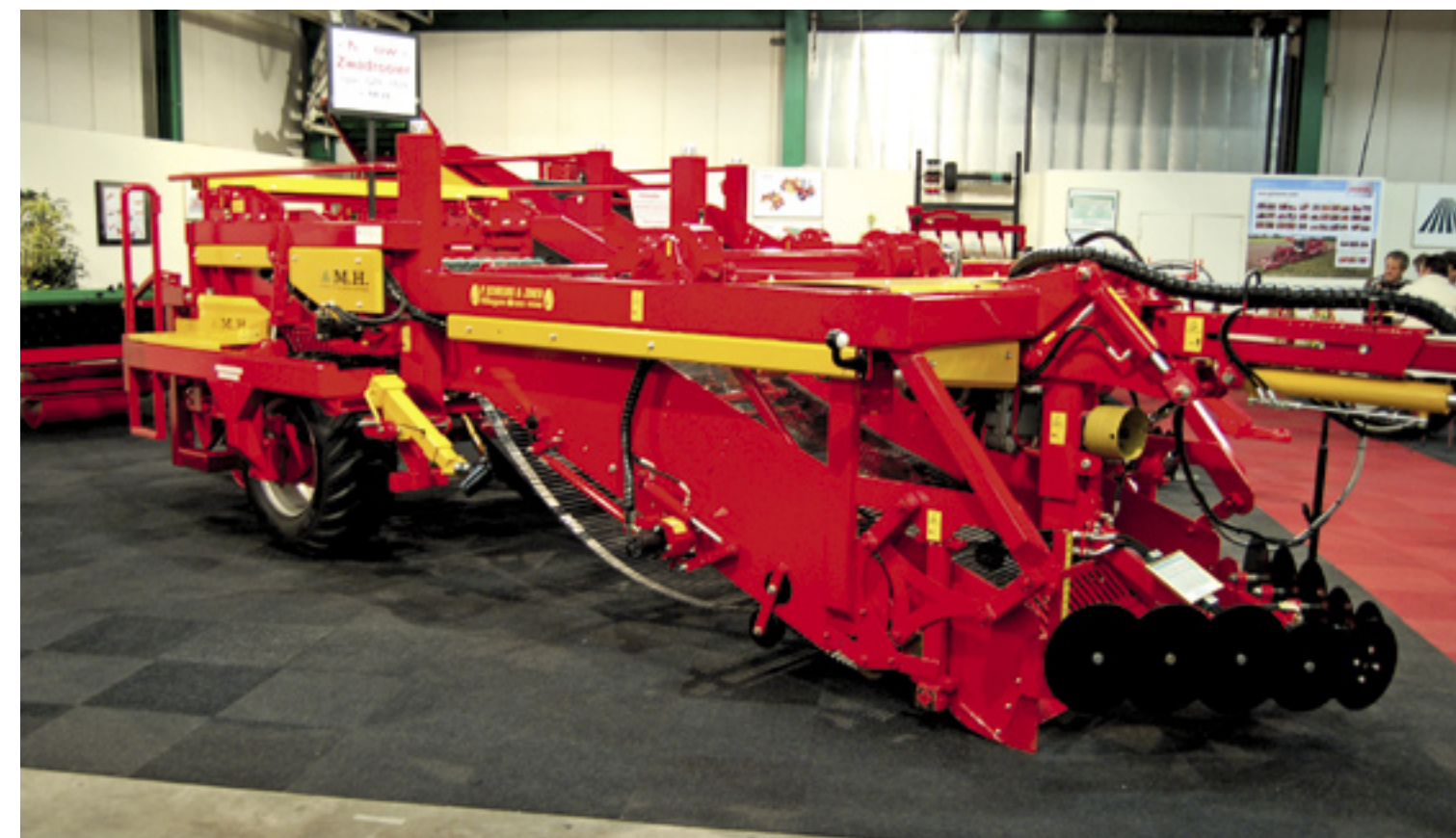
▲ MH introduceert met de GZR 1629 een korte en lichte voorraadrooier. Het eerste dat opvalt is de hoge trekboom met een hydraulische cilinder. Met deze cilinder kan de trekboom vlak voor de wendakker worden ingetrokken om zo ook het laatste deel van de rug te rooien en zo de kale kopakker zo kort mogelijk te houden. De bollen gaan over een 160 cm brede rooiketting naar een zevendelige vingerrol om daarna over een 50 cm korte zeef over een trilgoot in het zwad op de grond komen.
