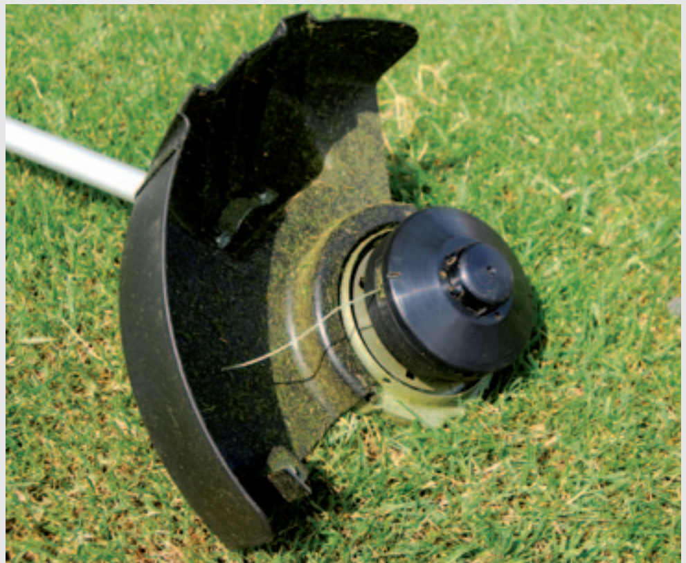
In de kop van de maaier is de elektromotor gemonteerd. Er loopt dus geen as meer door de steel van de machine. Dat vermindert het aantal trillingen.
