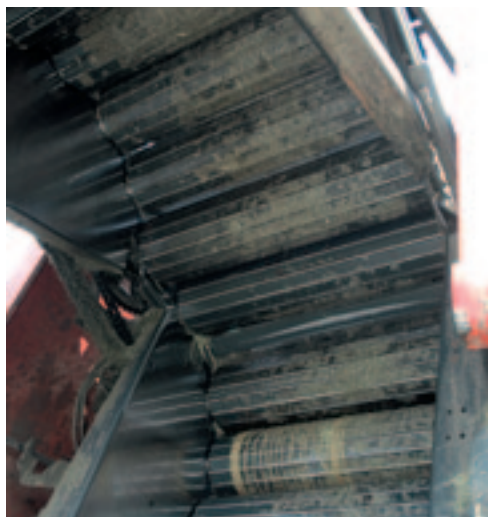
De meeste fabrikanten hebben gekozen voor een bermgrasper met een vaste kamer met aangedreven rollen rondom.
