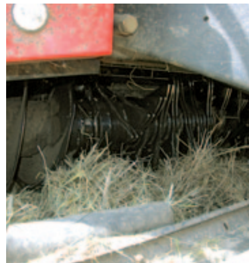
Een invoerrotor kan de capaciteit verhogen, maar er zijn ook bermenpersen die het zonder rotor juist wat beter doen.
