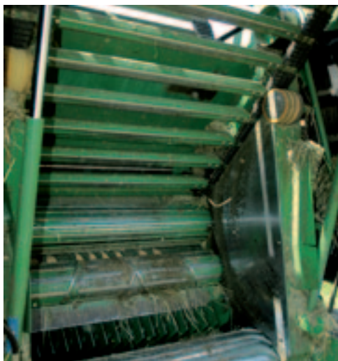
Als enige fabrikant heeft Krone bij de Comprima gekozen voor stille en sneldraaiende riemen met meenemers.
