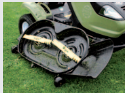
Het maaidek is zonder veel inspanning binnen een minuut onder de machine weg te halen en dan makkelijk te reinigen.
