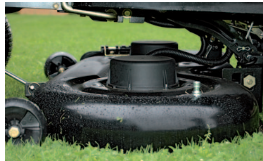
Elk van de beide messen heeft een eigen motor; het toerental is instelbaar op 1.800, 2.400 of 2.800 omw./min. De aandrijving via 'elektriciteitskabels' maakt dat het maaidek makkelijk onder de machine weg te halen is voor bijvoorbeeld het reinigen of het vervangen van de messen.
