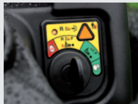
Om de messen bij het achteruitrijden door te laten draaien, moet de chauffeur eenmalig de oranje knop indrukken.
