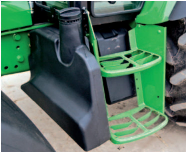
▲ De dieseltank heeft standaard een inhoud van 114 liter, maar hij is als optie ook verkrijgbaar met 130 of 150 liter. De treden lossen goed, geven goed grip, maar zijn niet al te groot. De onderste zit vrij hoog.
