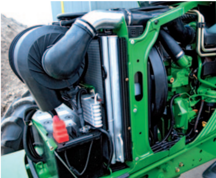
▲ Accu en luchtfilter zitten goed bereikbaar voorin de neus. De verschillende koelers zijn makkelijk te reinigen. De motorkap gaat als één geheel open (op de kleine zijpaneeltjes na). De motor presteert en drinkt goed.
