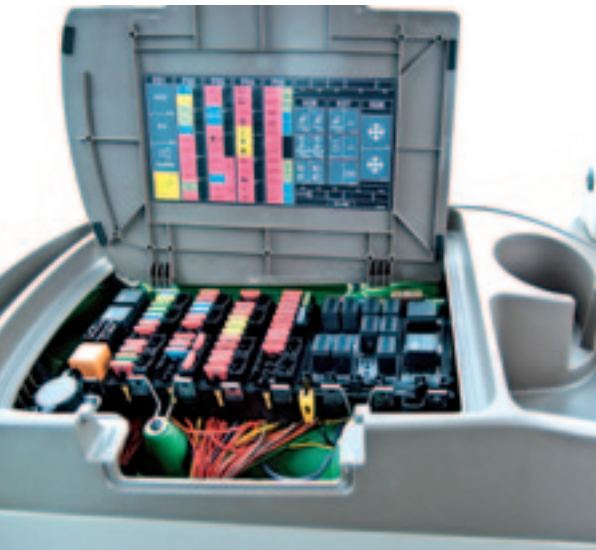
Goed bereikbare zekeringen en helder schema.
