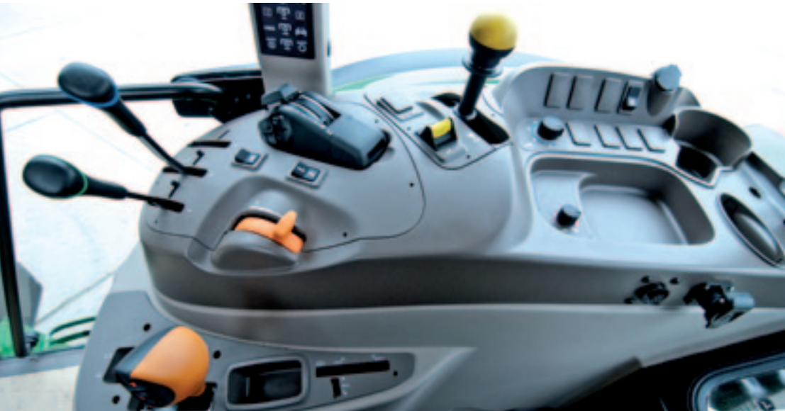
De rechterconsole is overzichtelijk; de kans op bedieningsfouten is gering. Linksvoor de versnellingspook.
