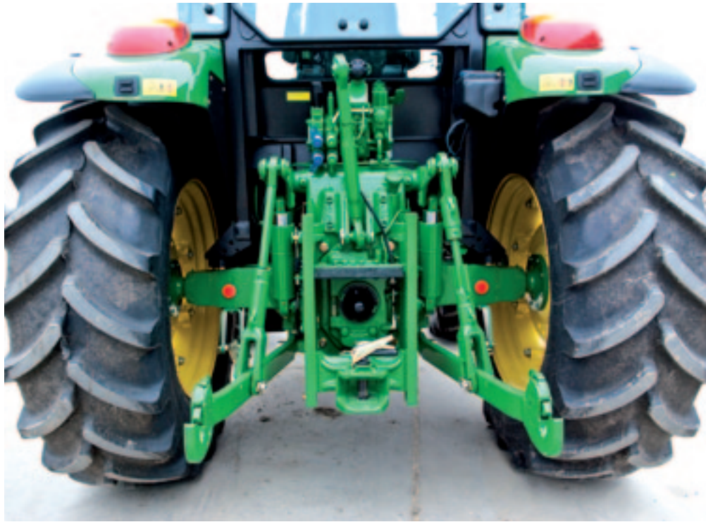
▲ De hef is vanaf beide spatborden te bedienen en bovenin bovengemiddeld krachtig. De stabilisatie voldoet goed; van de hefstangen heeft alleen de rechter ‘snelverstelling’. De snelverstelwagentrekhaak heeft negen hoogteposities. De ophanging van de topstang is ‘Amerikaans goed’ beveiligd.
