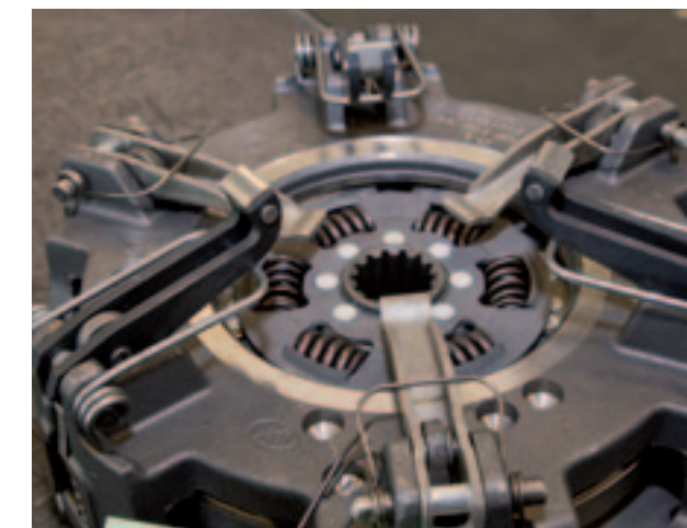
▲ Drie van de zes hefboomen nemen om en om de rijaandrijving voor hun rekening; de tussenliggende drie de aandrijving van de aftakas.
