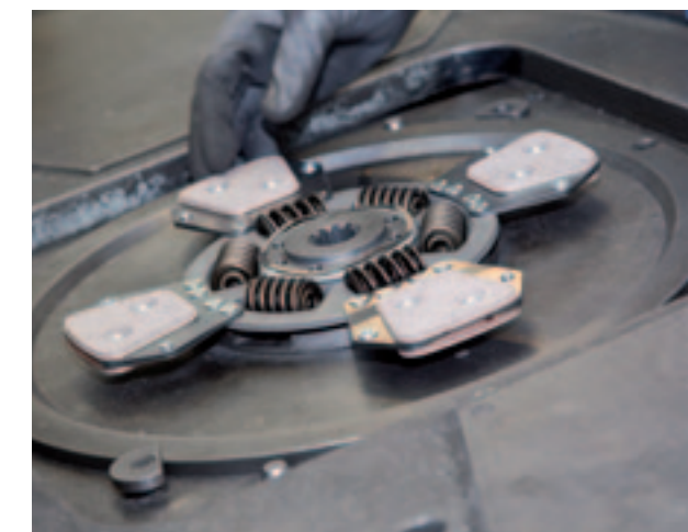
▲ Een frictieplaat van gesinterd materiaal; ze zijn er ook met vijf of zes 'pads'. De veren in het hart nemen de torsiedemping voor hun rekening.
