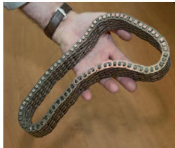
▶ De ketting voor de mechanische cvt die onder meer in de New Holland Boomer zit, brengt bij een schijfdruk van 7 ton een koppel tot 300 Nm over.
