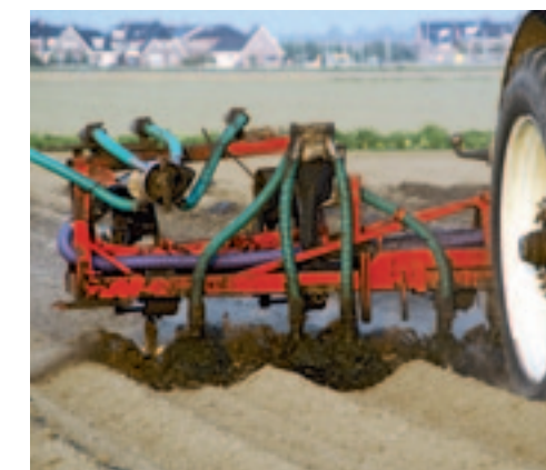
▲ De precisieverdeler van Agro-Invent is voorzien van sterwielen die mest inwerken en afdekken.
