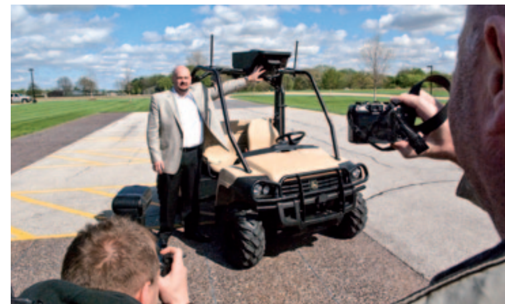
▲ De zelfrijdende Gator van John Deere vindt zelfstandig zijn weg over het terrein. Een bewegende camera op het frame, die ook kan inzoomen, houdt de omgeving in de gaten. Twee vaste camera's kijken voor- en achteruit. Temperatuursensoren en twee lasers scannen de omgeving af op dieren, mensen en obstakels.
