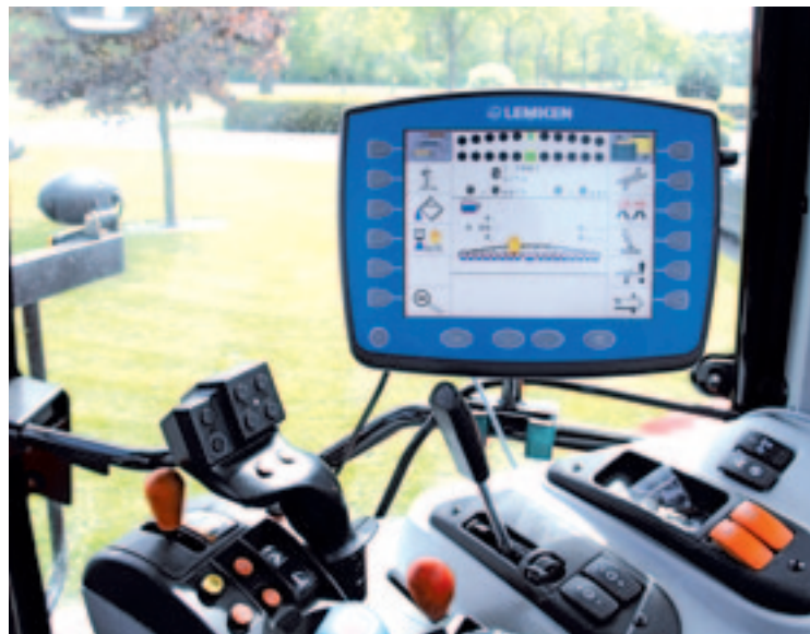
▲ De isobus compatibele Comfort-Terminal heeft een groot kleurenscherm. Met een joystick bedien je de hydraulische functies.
