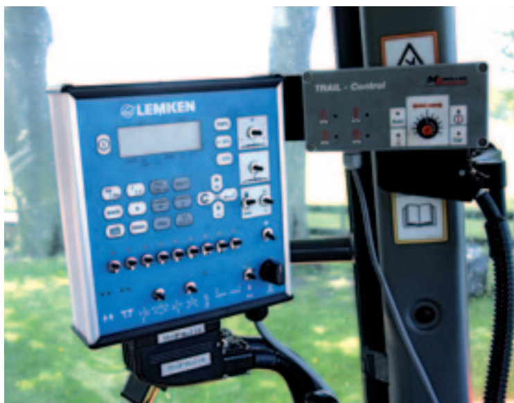
▲ De Spraydos computer van Müller is de simpelste terminal. Met het kastje rechts bedien je de disselsbesturing.
