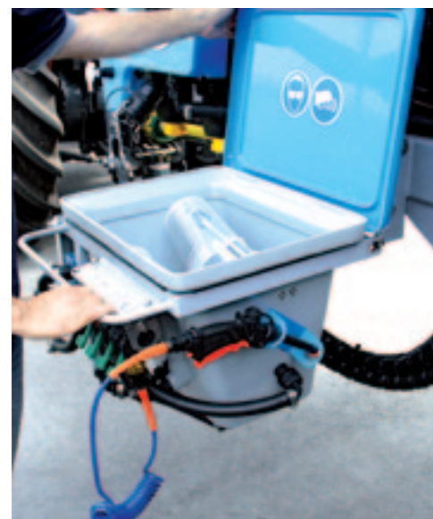
▲ De vul- en spoelbak klap je moeiteloos neer. Ook met poeders heeft de bak geen probleem.
