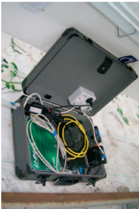
Figuur 5. Een meetkoffer met daarin de LICOR 840-A en de laptop voor dataregistratie.
