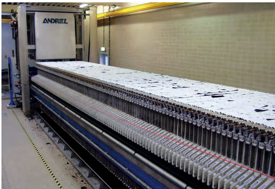
De volledig automatisch lossende membraanfilterpers in Emmen.
