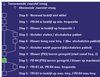
Figuur 2 beluchttingsregeling circuit 2 rwzi Meppel
