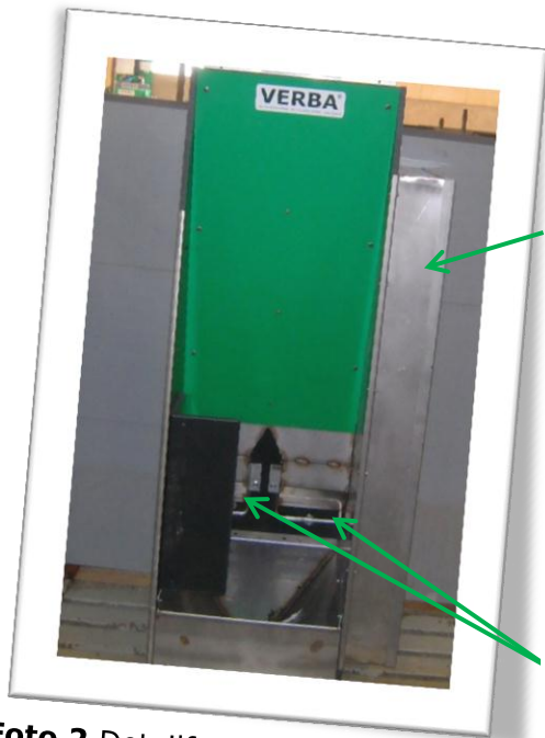
Foto 2 Detailfoto voerbak met twee uitdoseerpunten (A) en sensor rechts van bak (B)
