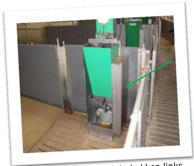
Foto 3 Locatie voerbak in hokken links van de controlegang. Voor sensor, zie pijltje.
